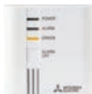
Błąd (czujnika, połączenia)
